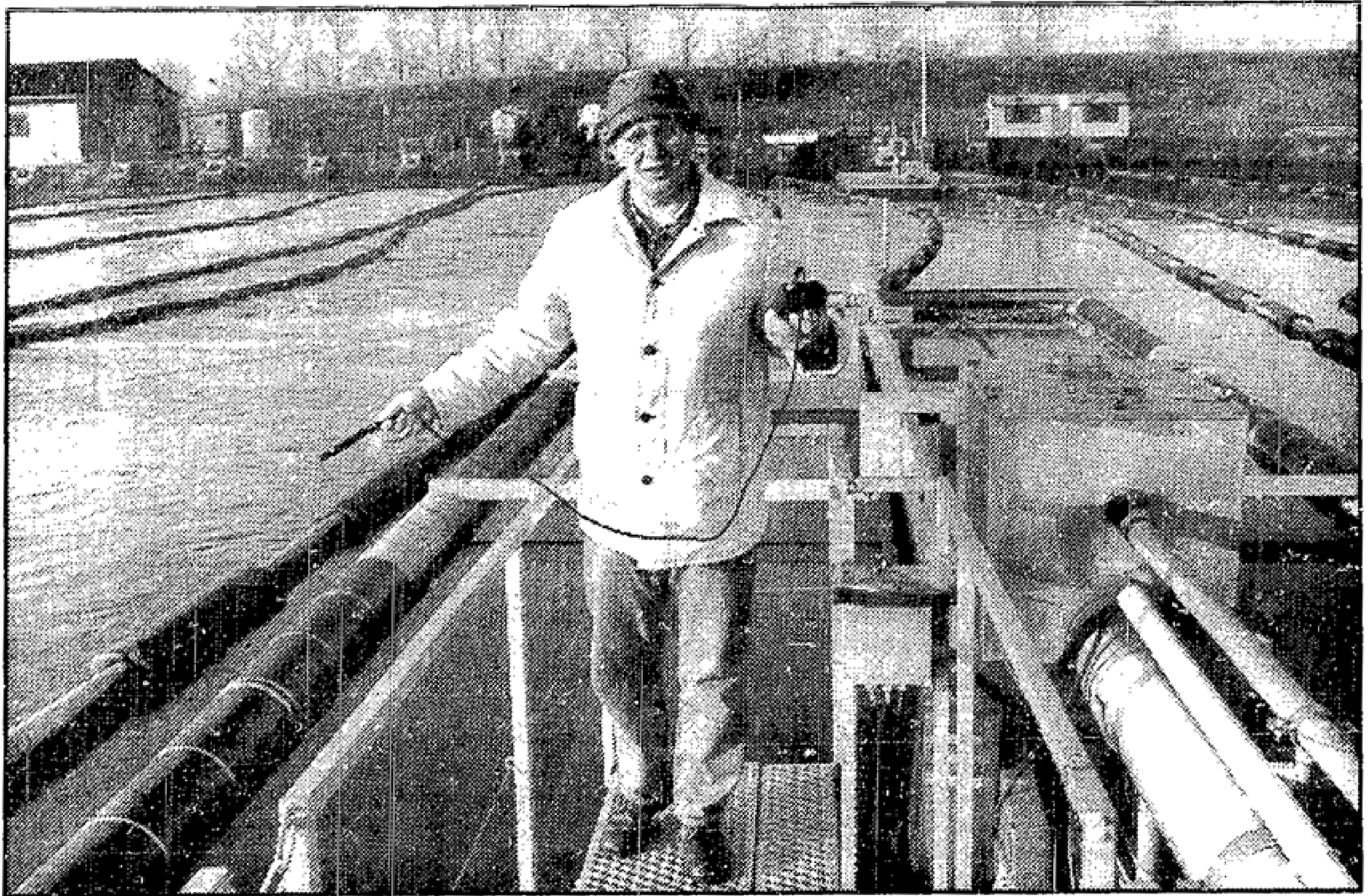
Einer täglichen Prüfung unterliegt das Abwasser in der biologischen Abwasserkläranlage in Beeskow. Dazu führt Hartmut Radcke eine Sonde ins Wasser, um Sauerstoffgehalt und Temperatur zu messen.
