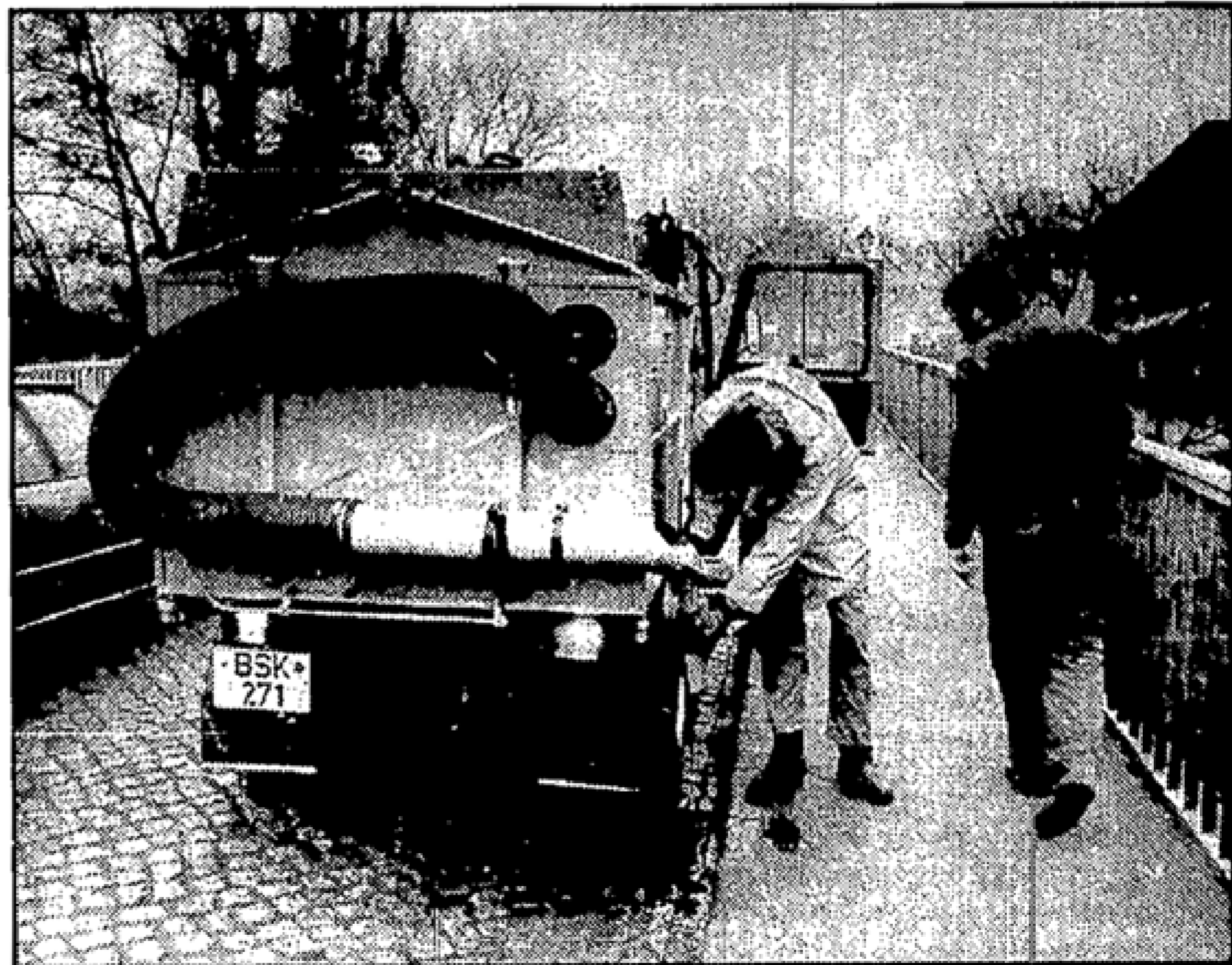
Das überschüssige Wasser, das die Maschine beim Kehren aufnimmt, wird über einen Straßenabfluß abgelassen.
